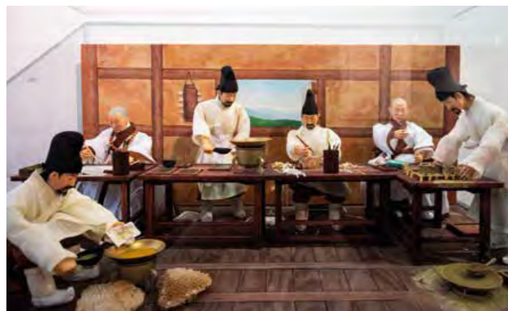
Modell des koreanischen Letterngusses im Wachsschmelzverfahren.
