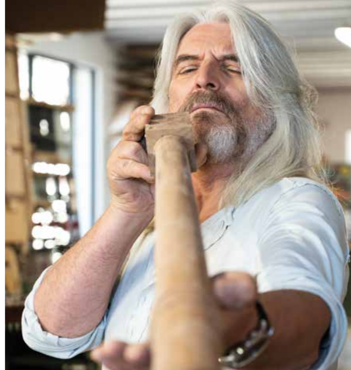
Prüfung des axialen Verlaufs einer Harfensäule (für eine Barockharfe Spaniens des 17. Jhdts.)
